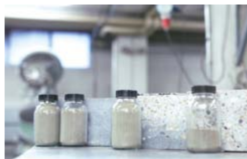
Probenplatten aus sog. Gradientenbetonen, bestehend aus granulometrisch optimierten Ökobetonen und ultrahochfestem Beton, einschließlich der zugehörigen mehlfinein Ausgangsstoffe
