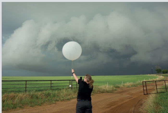
Start einer Hagelsonde in eine Supercelle. (Foto: Jannick Fischer)
